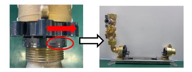
②台座のストッパをスライド管の溝に緩衝しないところまで緑矢印方向に工具を用いて倒す。 (スライド管が突起部によって固定されているため一時的に倒す)
