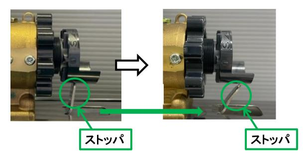
③スライド管を手で押さえながらハンドルをSの方向へ回転させ、スライド管を緩ませる。
