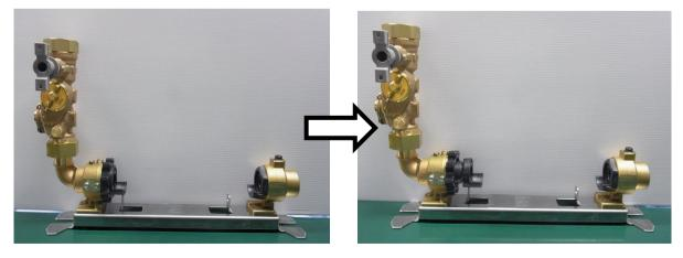
★水道メーターもしくは代用管を取り外した状態にて、ハンドルをSの方向へ回転させるとスライド管が緩みます。
