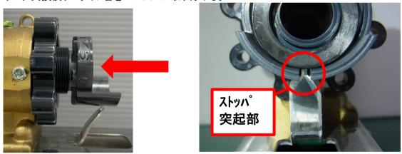
★スライド管をハンドル部に押し込んだ後、工具等を使用して台座のストッパを元の垂直な状態にしてください。 その際、ストッパの突起部をスライド管に合わせて下さい。
